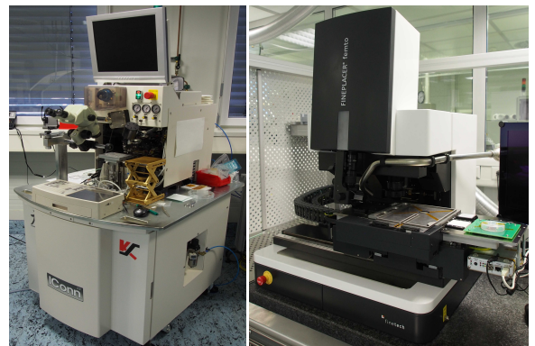
Bondermaschinen am IPE: Kulicke & Soffa IConn Ball-Bonder (links), Finetech Fineplacer® femto Flip-Chip-Bonder (rechts)
